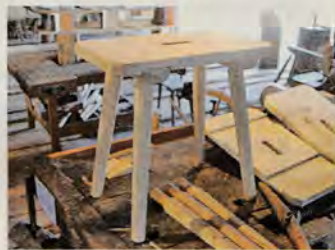
Lädt zum (Be)Sitzen ein: ästhetischer Hocker aus Massivholz, traditionell ohne Nagel und Leim gefertigt.
