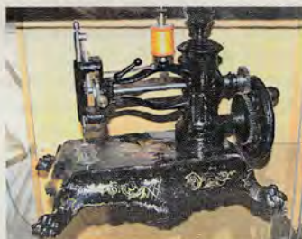
Das älteste Exponat: ein Modell von Clemens Müller, Dresden: ab 1855 erhältlich, Handkurbelantrieb, einfacher Kettenstich
